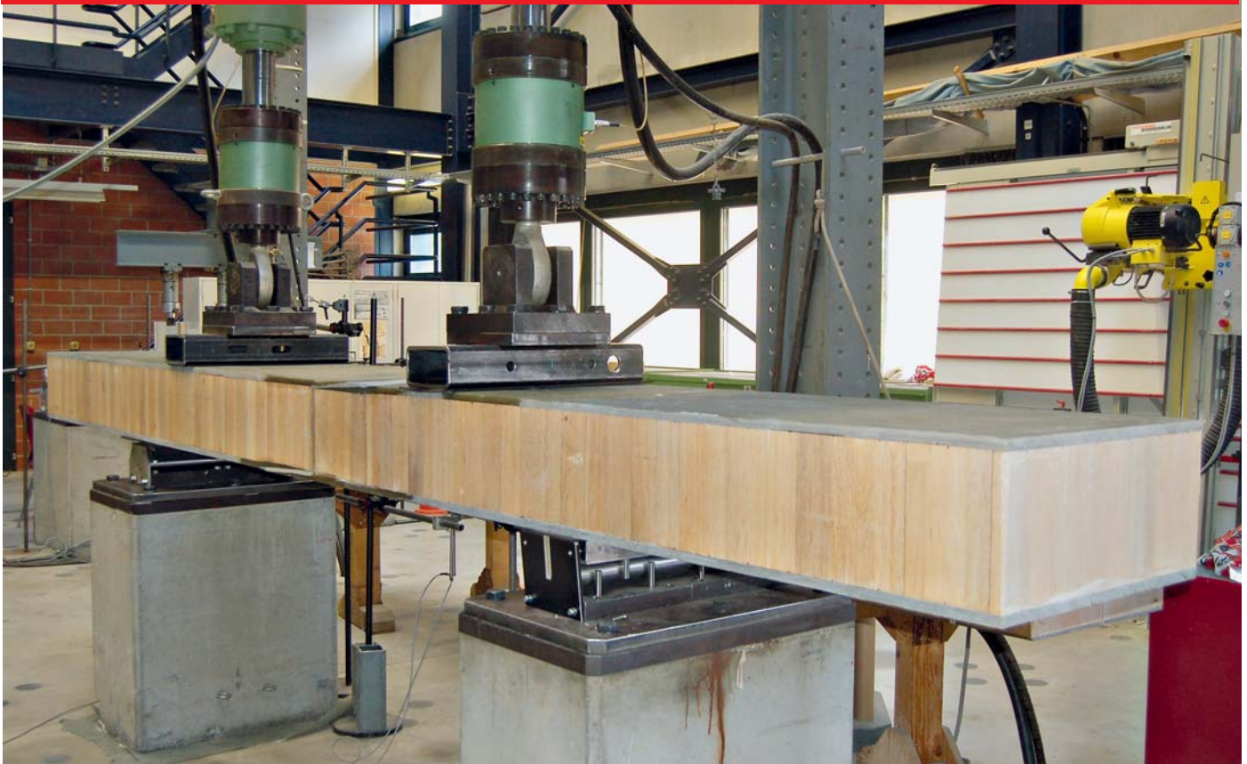
Ermüdungstest an einer Probe mit realen Querschnittsdimensionen
